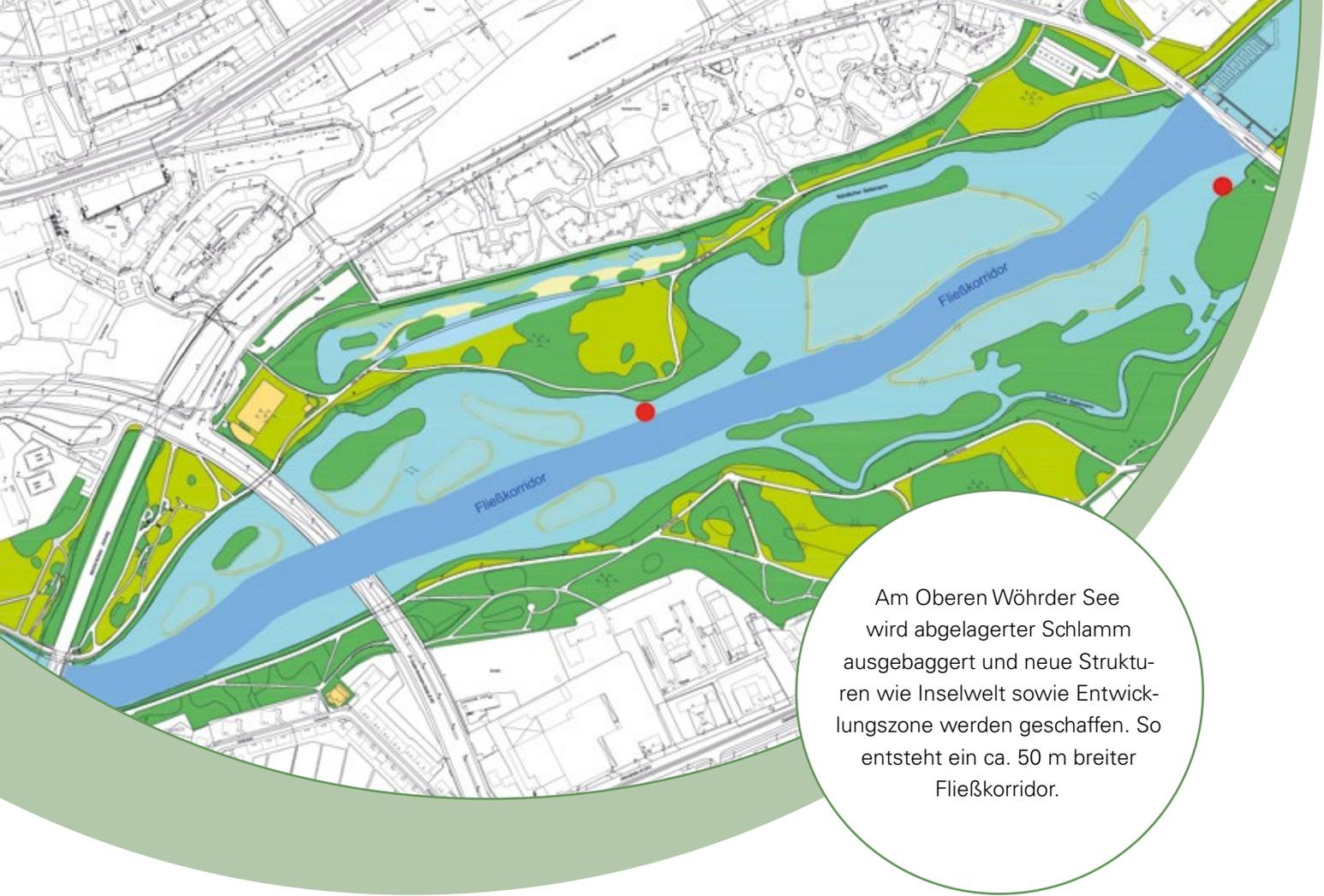
Am Oberen Wöhrder See wird abgelagerter Schlamm ausgebaggert und neue Strukturen wie Inselwelt sowie Entwicklungszone werden geschaffen. So entsteht ein ca. 50 m breiter Fließkorridor.
